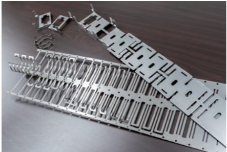
右から左に進むにつれて、金属の板が加工され、徐々に部品へと形が整っていきます
